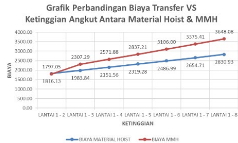
Gambar 4 Hubungan antara Biaya dan Ketinggian Transfer Material dengan Menggunakan Material Hoist dan Manual Material Handling .
