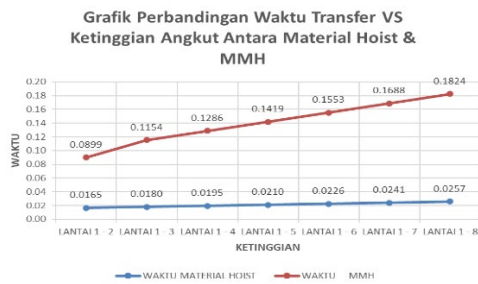
Gambar 3 Hubungan antara Waktu dan Ketinggian Transfer Material dengan Menggunakan Material Hoist dan Manual Material Handling
