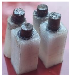
Gambar 2. Holder dan pin kampas rem.
