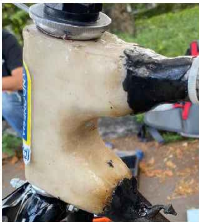
Gambar 12. Headtube setelah diuji.
