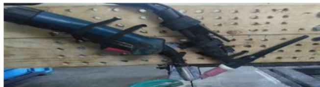
Gambar 4. Aplikasi Konstruksi Torch DE-GMAW.
